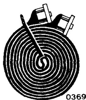
Druckschlauch zusammengerollt mit Rollschlauchriemen
